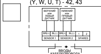
2 x 2-проводной Датчик (Y, W, U, T) - 42, 43
